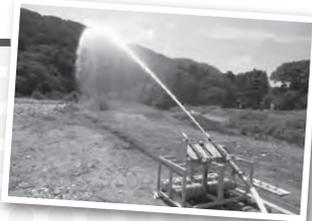
去る7月19日(水)、真夏の強い日差しが降り注ぐ中、弊社可搬消防ポンプ及び船外機の製造工場がある長野県駒ヶ根市。その市のほぼ真ん中を南北に流れる天竜川の河川敷で、ト一ハツ可搬消防ポンプVF63ASの1,000m送水試験が行われました。今回B2級可搬消防ポンプの性能を改めて実証する為の試験として、消防ホース50本(20m×50=1,000m)を連結、延長して一線放水をすると言う、非常にスケールの大きい試験を行うこととなり、述べ30名近い方のご協力をいただき中で試験が行われました。晴天の中での作業、ポンプの設営からホース50本の展開、放水銃の設置など初めての事が多く非常に苦勞をしましたが、無事設営が完了しいざ放水試験へ。VF63AS(B2級)においてはポンプ本体圧1.1MPaで送水、1,000m先で筒先圧力:0.2MPa、放水量:390L/minという結果となり、B2級可搬ポンプでも1,000m先で消火に有効な放水ができることが分かりました。
